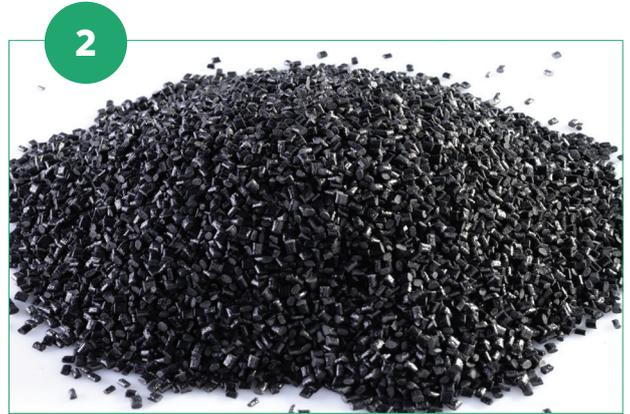
Auf dieser Basis produzieren wir einen speziell entwickelten PET-Verbundstoff, der weltweit einzigartig ist. Er weist Schlagfestigkeit, Steifigkeit und Zugfestigkeit auf.
